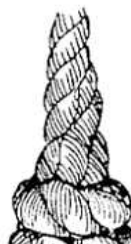
FIG. 116.—Wall knot (tucked).
